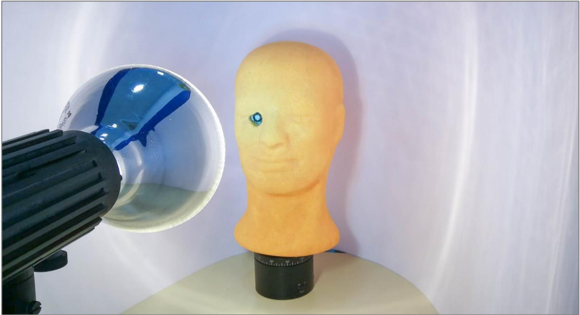
Slika 4: Pobarvan model človeške glave na vrtljivem podstavku in z nameščenim UVB-senzorjem
