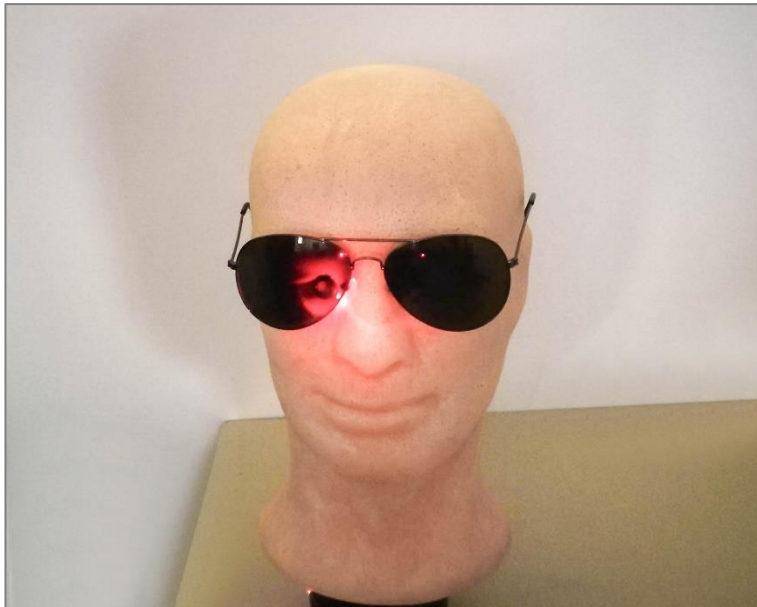
Slika 12: Mesto prehajanja svetlobe v senzor mimo leč
