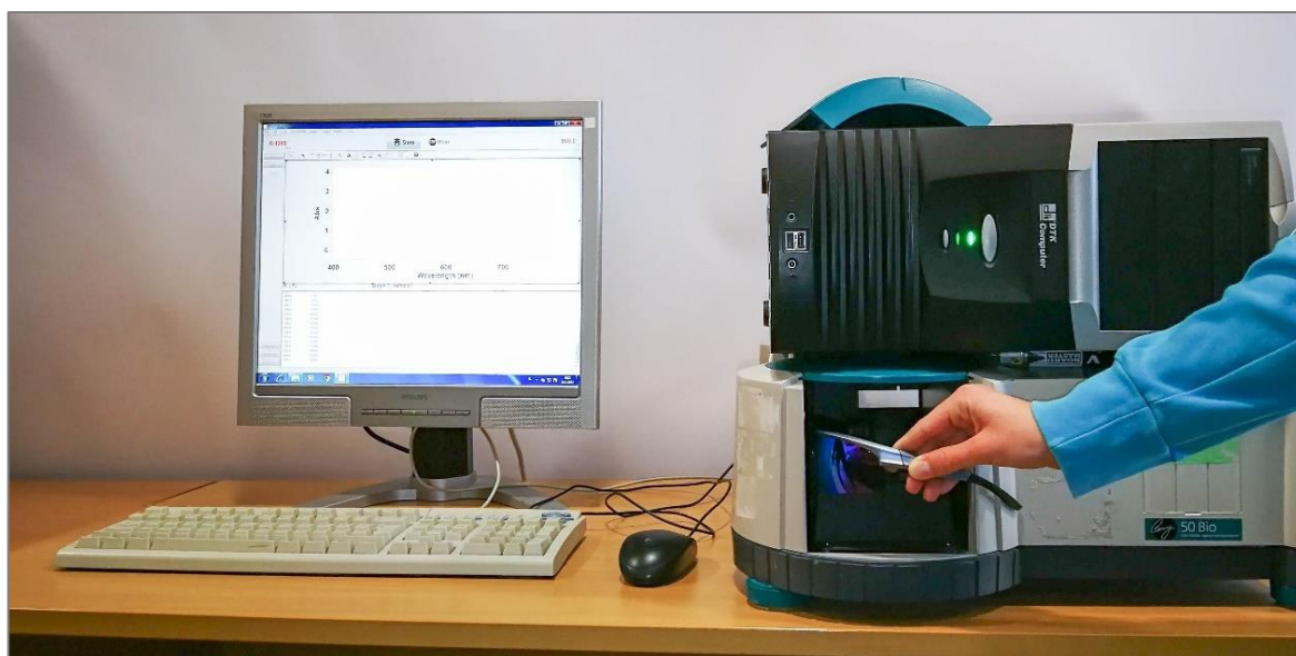
Slika 11: Merjenje transmittance različnih valovnih dolžin z UV-VIS spektrofotometrom
