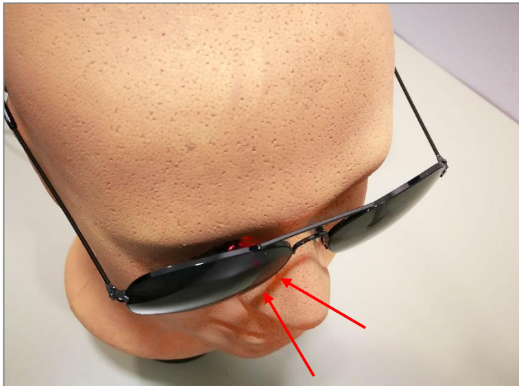
Slika 13: Koti prehajanja svetlobe v senzor mimo leč
