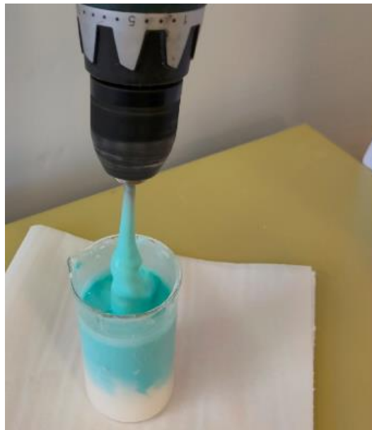
Slika 16: Zaradi hitrosti vrtenja tekočina okoli palice spremeni viskoznost
