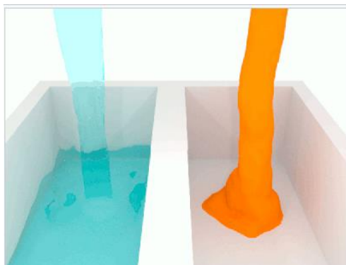
Slika 2: Tekočina na levi ima nižjo viskoznost od tekočine na desni
