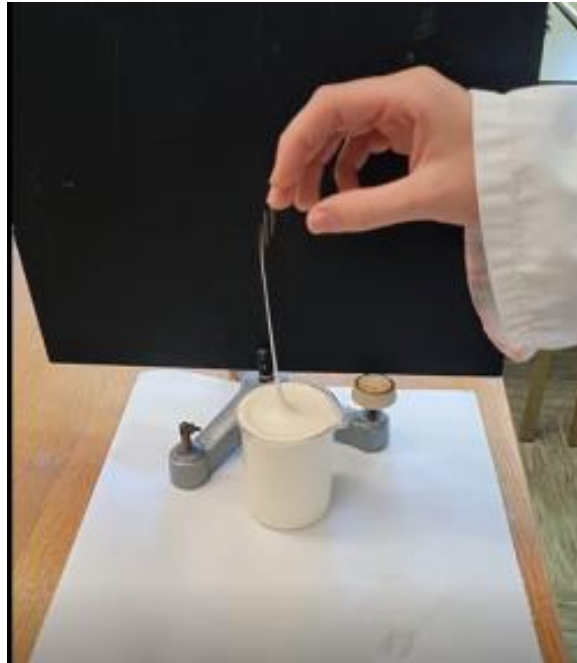
Slika 26: Smetana in pljusk; pljusk značilen za newtonske tekočine
