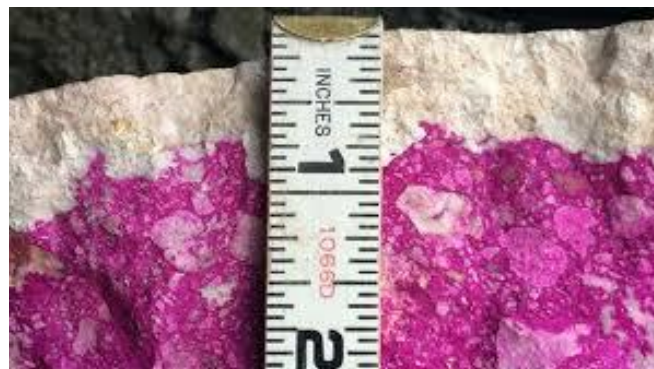
Slika 7: Karboniziran in nekarboniziran del betona
