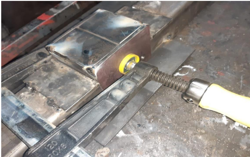
Slika 18: Vpet nosilec v šabloni
