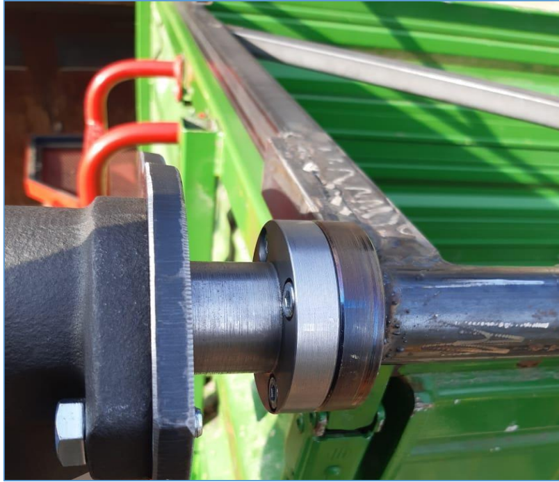
Slika 21: Povezava hidromotorja s prirobnicama (Osebni vir)
