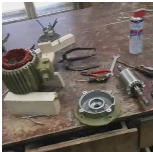
Slika 16: Razstavljen elektromotor in menjava ležajev
