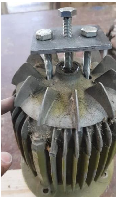
Slika 15: Doma narejeno orodje za odstranitev ventilatorja
