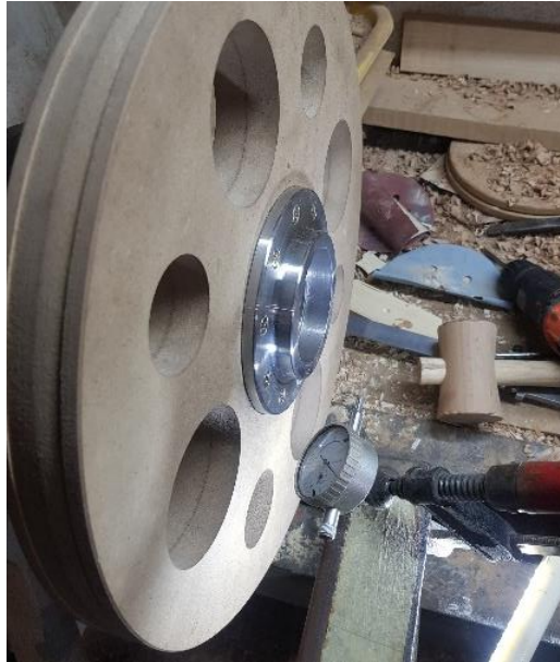
Slika 42: Sestava kolesa in umerjanje z merilno uro
