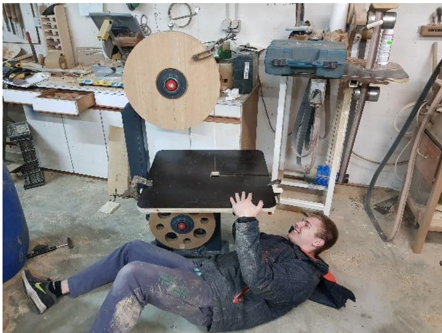
Slika 46: Privijanje mize na vodila
