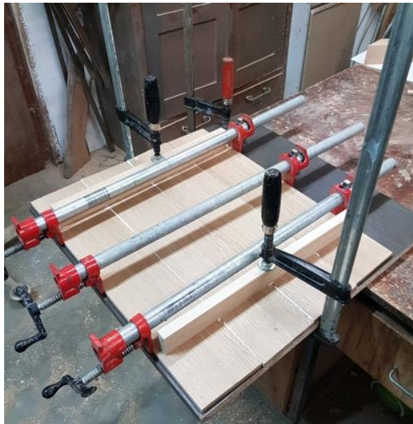
Slika 40: Lepljenje desk za sprednji pokrov ščita
