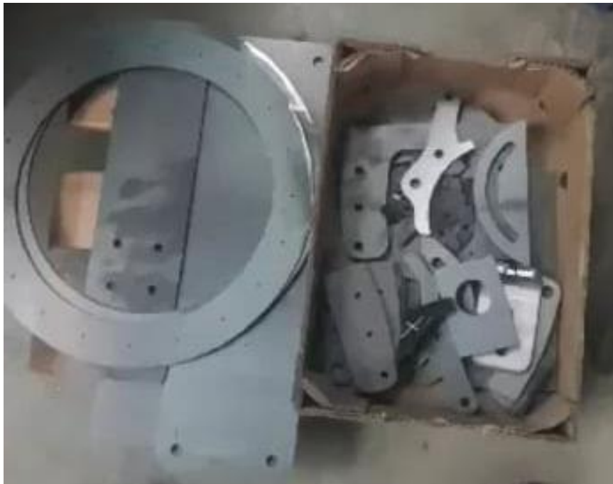
Slika 19: Material z laserskega razreza
