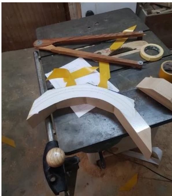
Slika 38: Lepljenje načrta na obrobo ščita
