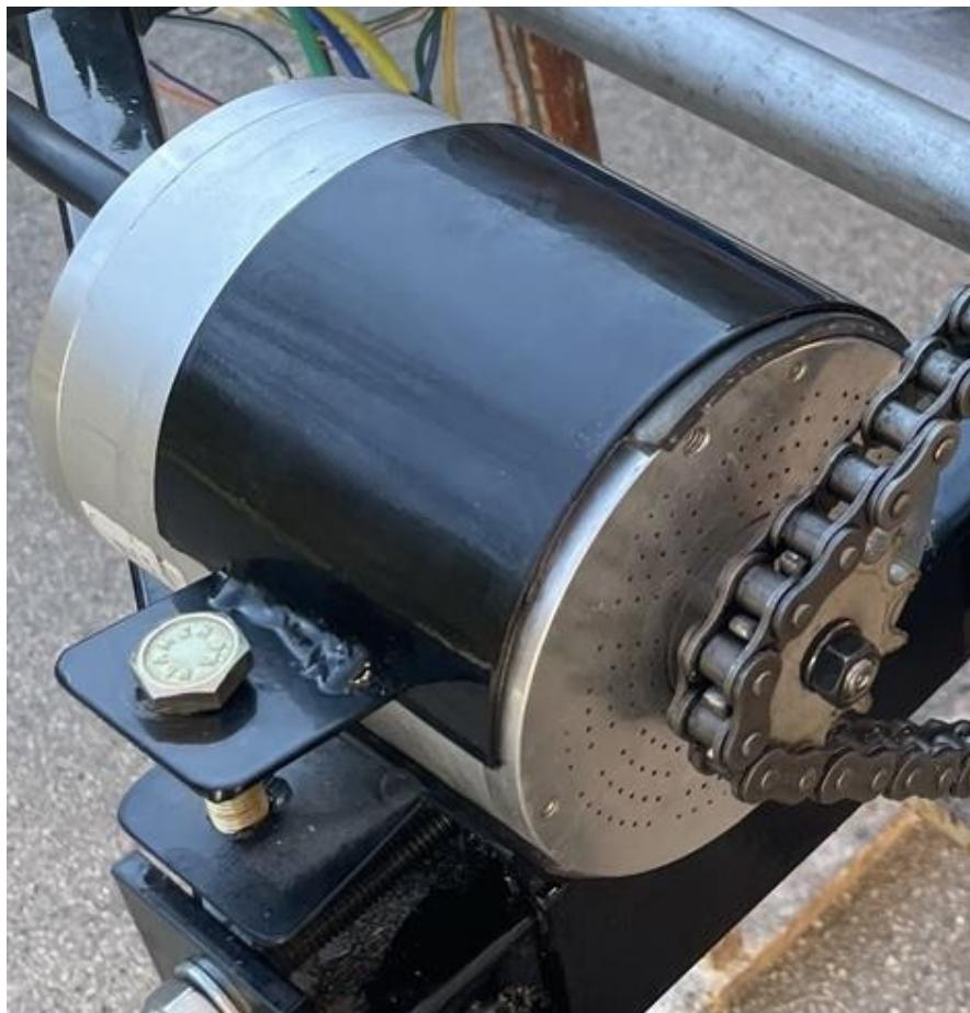
Slika 17: Brezkrtačni elektro motor (osebni vir)
