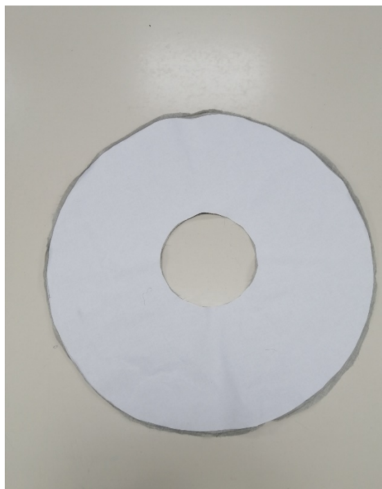
Slika 29: Lepljiva medvloga nalepljena na tkanino. (Vir: lasten vir)
