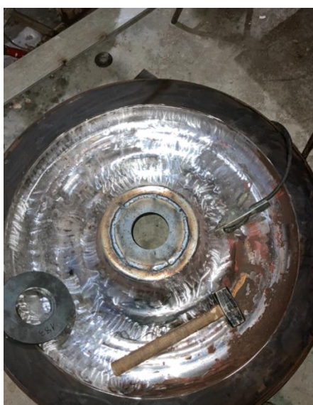
Slika 19: Varjenje distančnika na kolo
