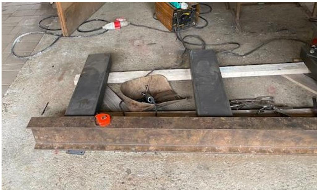
Slika 8: Izdelava osnovnega dela deske
