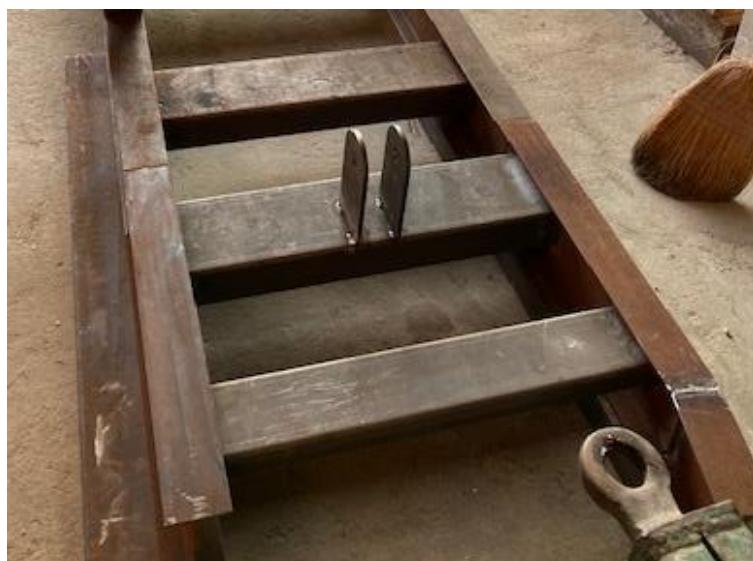
Slika 13: Stranski sklop z vpetjem za cilinder
