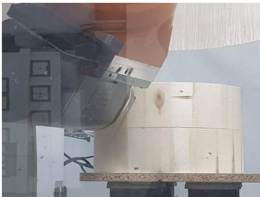
Slika 19: Vrtanje lukenj za okovje s CNC strojem. (Slikovni viri: Slika 19).
