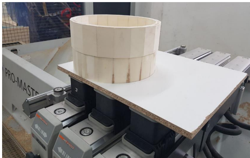
Slika 18: Obod vpet pred drugo fazo obdelave s CNC strojem. (Slikovni viri: Slika 18).
