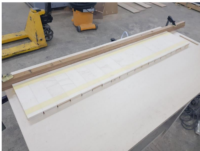
Slika 12: Segmenti, razporejeni in zalepljeni v plašč. (Slikovni viri: Slika 12).
