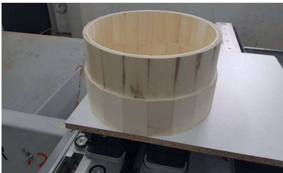
Slika 17: Obod po prvi fazi obdelave s CNC strojem. (Slikovni viri: Slika 17).
