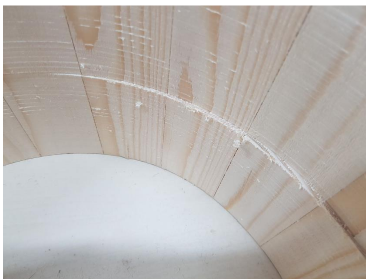
Slika 20: Neusklajenost polovic pri obdelavi s CNC strojem. (Slikovni viri: Slika 20).
