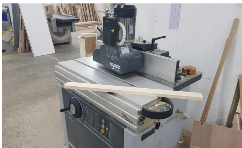
Slika 15: Rezkanje kotov na trakovih z rezkarjem. (Slikovni viri: Slika 15).
