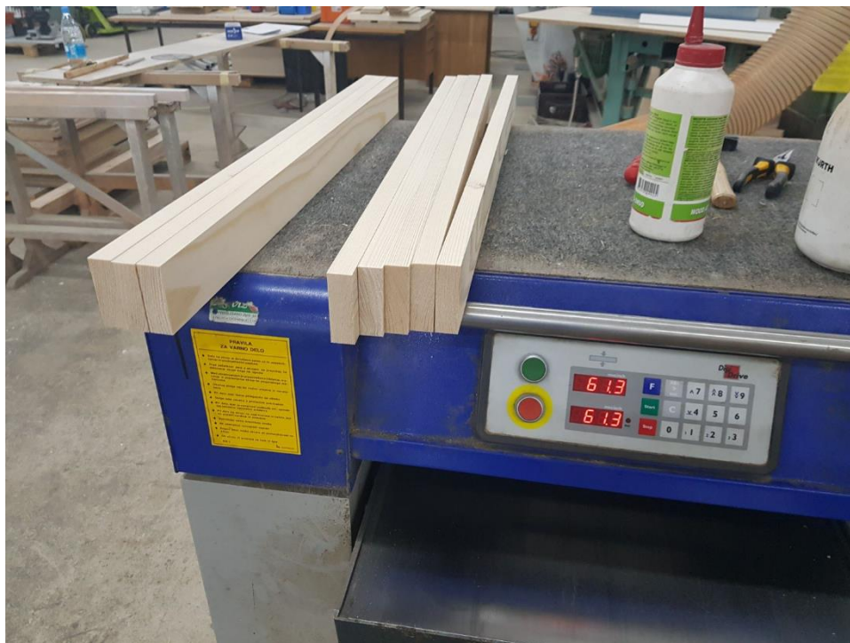
Slika 14: Debelinjenje trakov na enako širino. (Slikovni viri: Slika 14).
