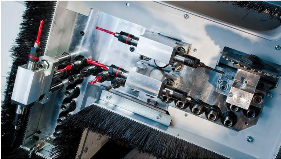
Slika 7: Vrtalna enota na lesnoobdelovalnem CNC stroju. (Slikovni viri: Slika 7).
