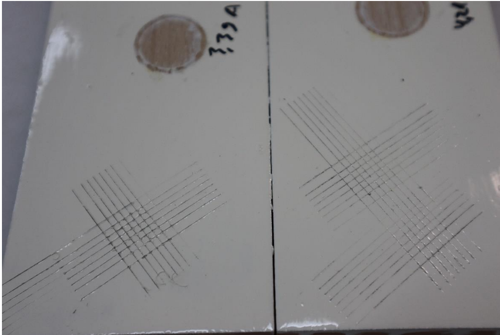
Slika 15: rezultati testa prečnega rezanja
