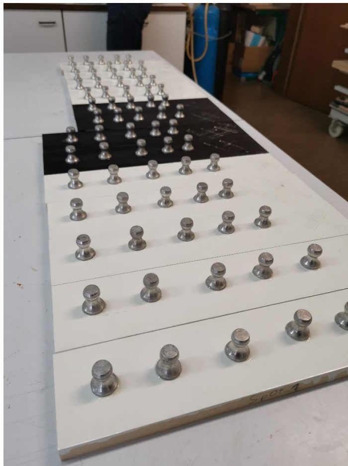
Slika 12: lepljenje pečatov na letvice
