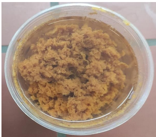
Slika 10: Rdeče obarvane flokule ob dodatku železovega koagulanta
