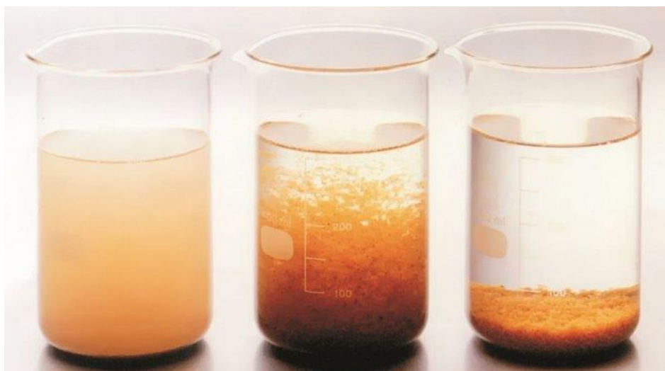
Slika 4: Koagulacija, flokulacija in sedimentacija (od leve proti desni) [18]
