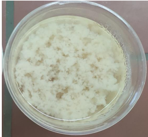
Slika 11: Svetlo obarvane flokule ob dodatku aluminijevega koagulanta
