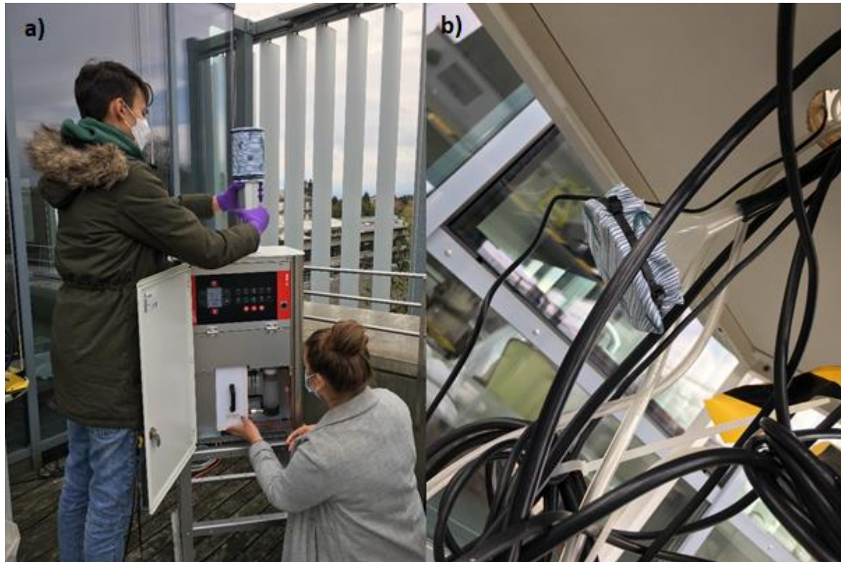
Slika 8: a) Vzorčevalnik in b) SMPS z nadetima dvema slojema bombaža
