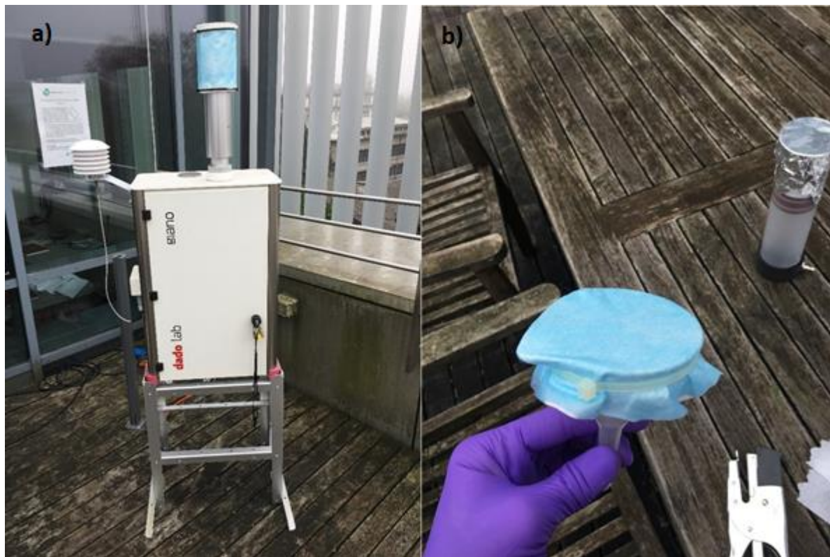
Slika 7: a) Vzorčevalnik in b) lij z nadeto kirurško masko; slednja sem namestil na cev za dovod zraka v SMPS
