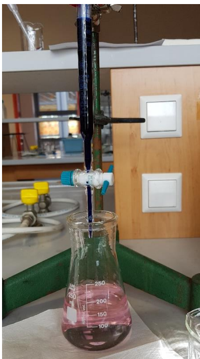
Slika 8: Titracija vzorca do svetlo roza obarvanja (osebni arhiv).
