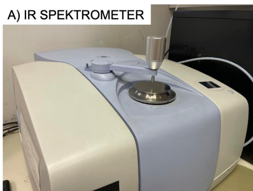
Slika 9: A) IR-spektrometer Perkin Elmer spectrum 100 na odseku K5, IJS, na katerem smo izvedli spektrografske meritve. B) Približan makroskopski posnetek konice in detektorja, na katerega nanese vzorec.
