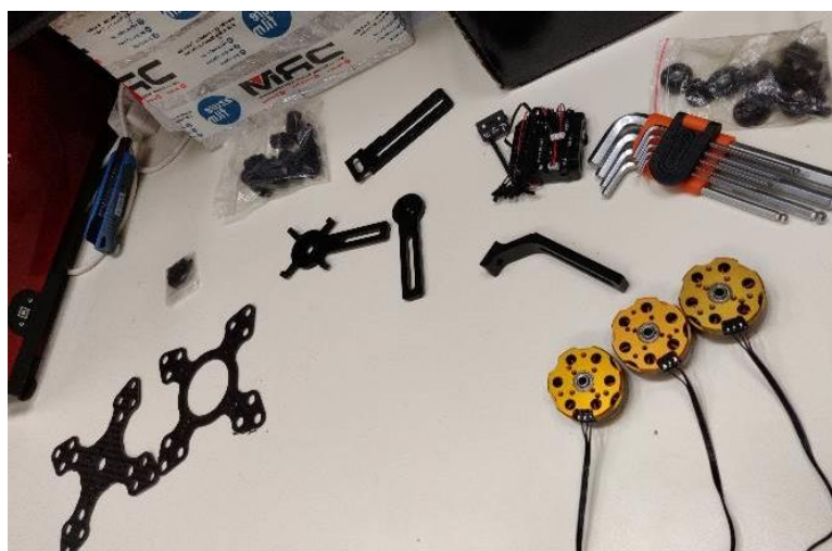
Slika 36: Sestavni deli stabilizatorja
