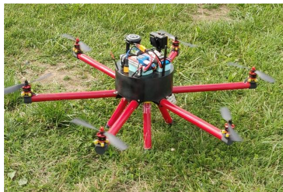
Slika 4: Skrajšani kraki alumplast okvirja
