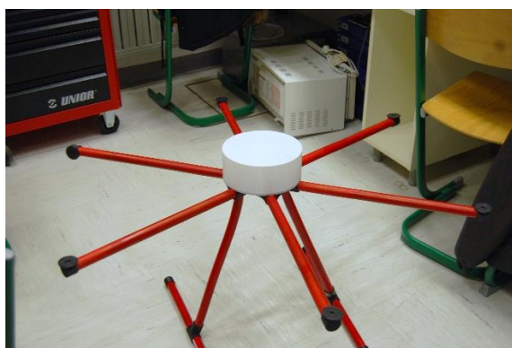
Slika 2: Okvir heksakopterja s pokrovom komponent
