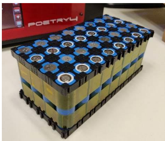
Slika 33: Osnova za baterijski pack iz 18650 baterij
