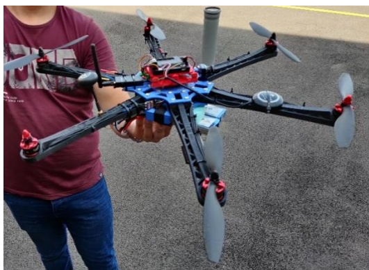
Slika 9: Sestavljen 3D tiskan okvir
