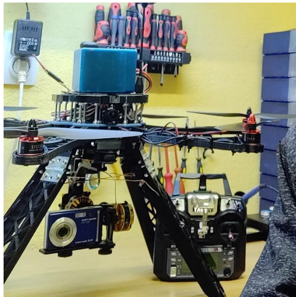
Slika 13: Montirane zlozljive noge
