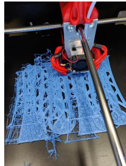
Slika 6: Ponesrečen tisk (zamik slojev)
