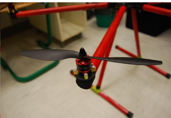
Slika 47: Motor na 3D-tiskanem nosilcu
