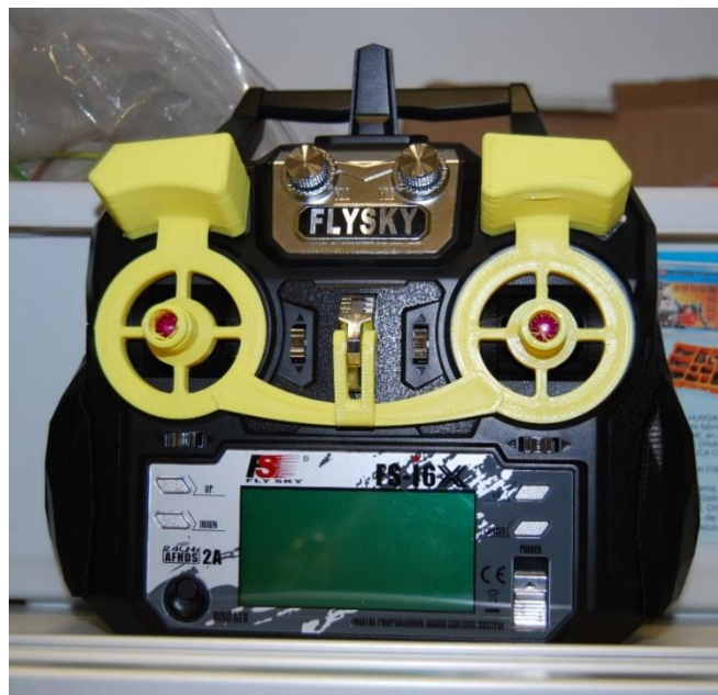
Slika 27: Oddajnik i6x in varovalo upravljalnih palic in stikal
