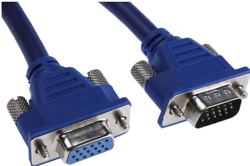
Slika 4: Priključka analognega VGA vmesnika VIDEO.
