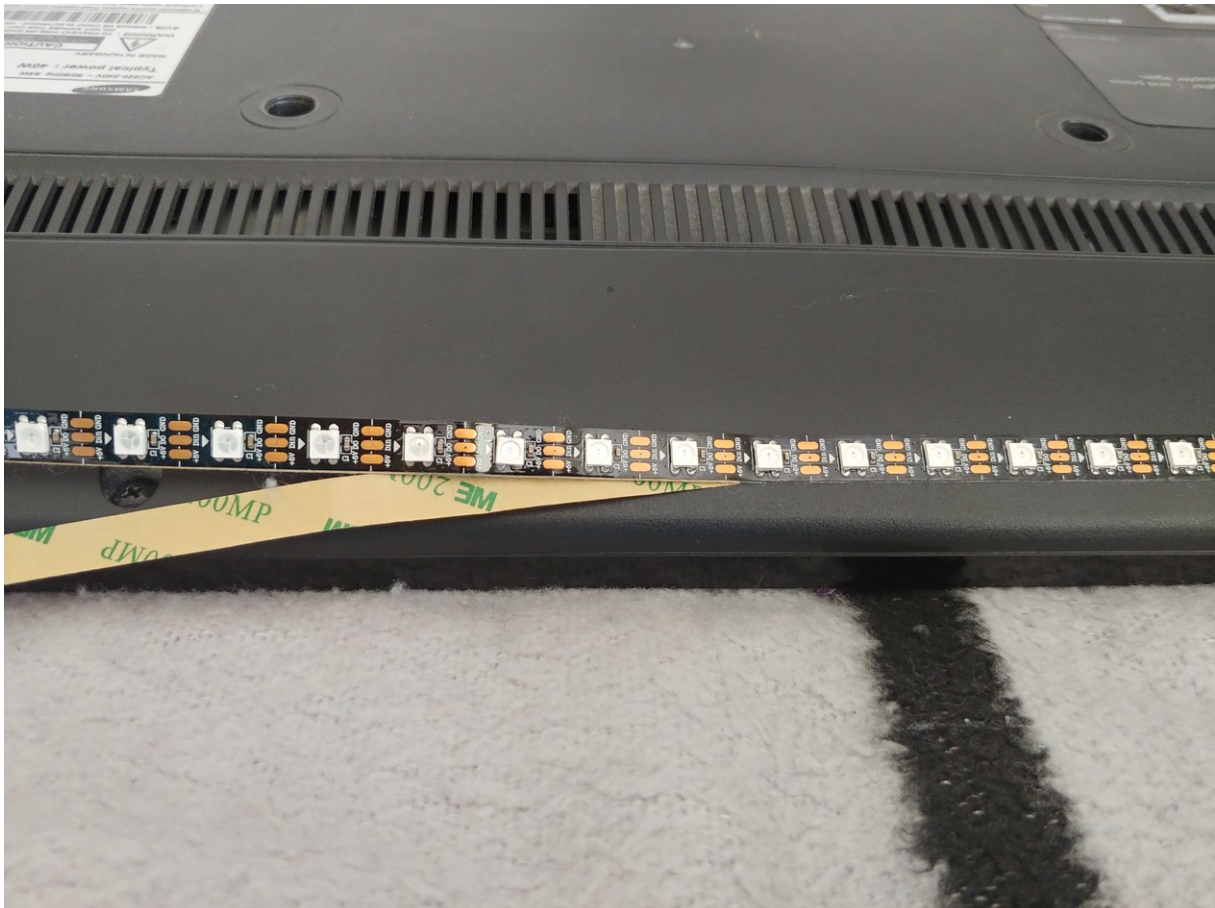
Slika 18: Montaža LED traku na hrbtno stran televizijskega zaslona
