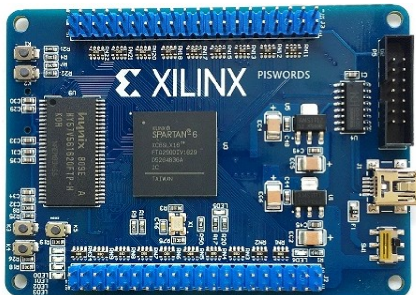
Slika 13: Kupljena razvojna ploščica z FPGA integriranim vezjem XC6SLX16
