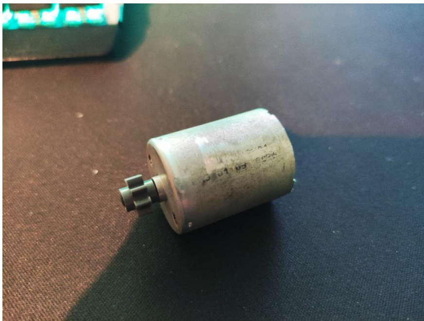
Slika 11. DC motor uporabljen v Hydro-polnilcu
