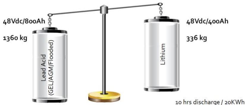
Slika 17: Primerjava baterij po energiji praznjenja (vir: victron energy)
