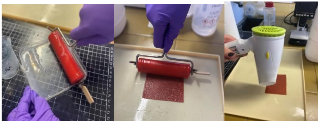
Slika 11 Nanašanje in sušenje CNF premazov.
