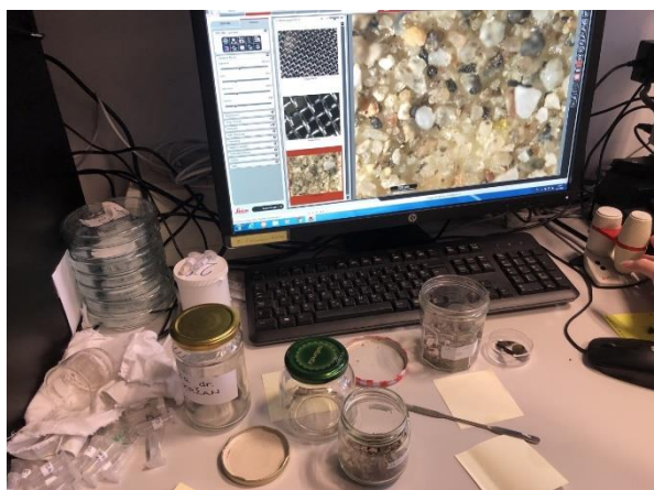
Slika 35: računalnik in program, ki je bil vezan na stereomikroskop
