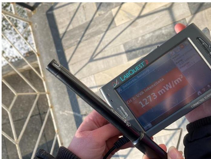
Slika 4: Senzor za merjenje UVA žarkov in vmesnik z ekranom
