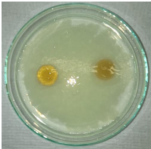
Slika 11: Gojišče z vzorcema medu, od leve: M2019, M2020. 333,15 K (60 °C), pred inkubacijo
