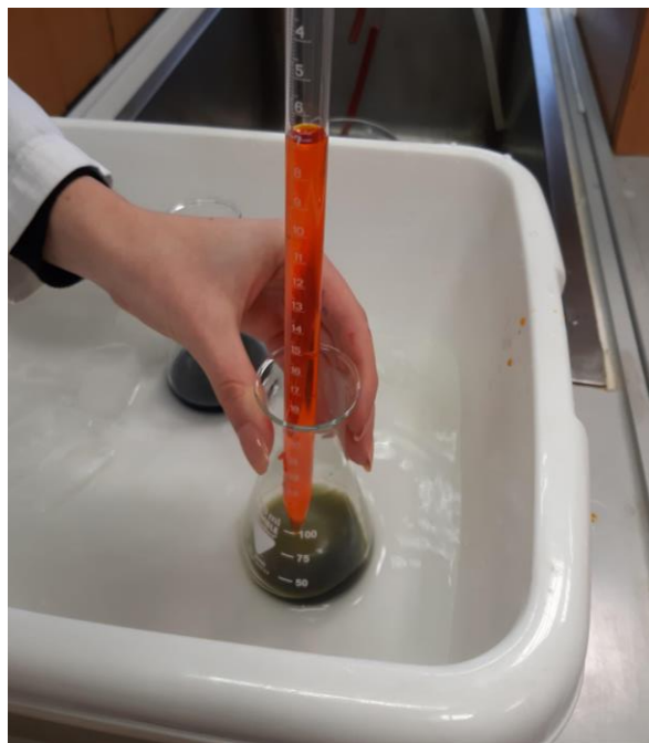
SLIKA 8: DODAJANJE KALIJEVEGA DIKROMATA V VZOREC (LASTNI VIR)
