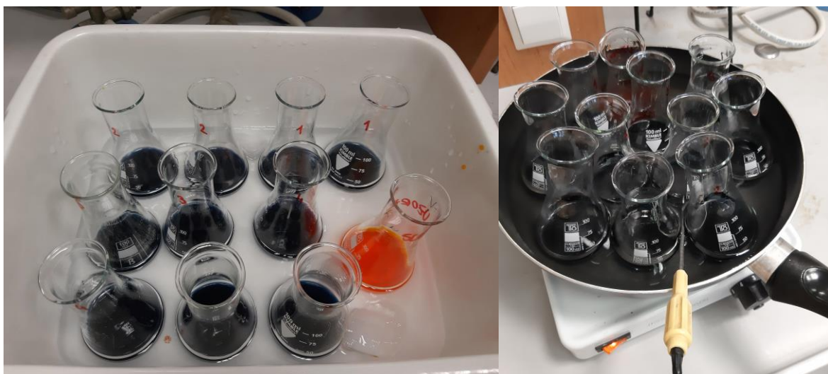
SLIKA 9: VZORCI V HLADNI VODNI KOPELI (LEVO) IN SEGREVANJE VZORCEV (DESNO) (LASTNI VIR)
