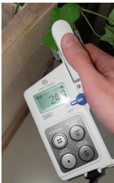
Slika 2: Merjenje s klorofilmetrom (SPAD - 502 Plus)
