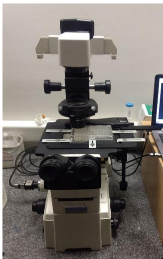
Slika 4: Invertni svetlobni mikroskop (Vir: Last avtorjev in mentorjev).
