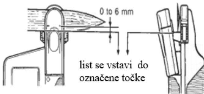
Slika 16: merilna glava klorofilometra s senzorjem
