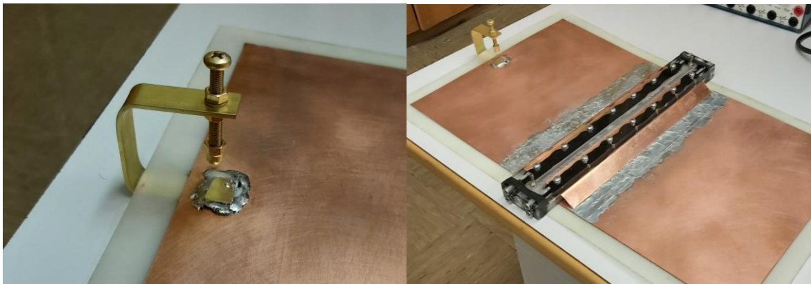
Slika 17: Spajkanje iskrišča na visokonapetostni kondenzator.
