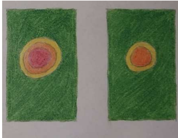
Slika 14: Prikaz gostote magnetnega polja na sprednji strani (leva slika) in zadnji strani (desna slika) za Samsung Galaxy A8. Najmočnejše magnetno polje se nahaja spredaj na sredini (rdeča barva) in znaša 1, 113 mT. Najšibkejše magnetno polje se nahaja na sprednji zgornji strani in znaša 0, 003 mT. Slika: Eva Rant
