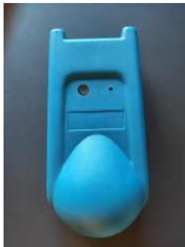
Slika 10: Dozimeter Antenessa EME Spy 120. Foto: Jure Ausec
