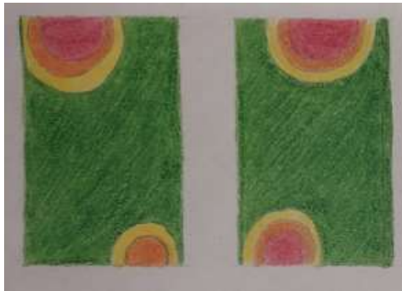
Slika 15: Prikaz gostote magnetnega polja na sprednji (leva) in zadnji (desna) strani za Samsung Galaxy S10 Lite. Najmočnejše magnetno polje se nahaja zgoraj na zadnji strani (rdeča barva) in znaša 2,638 mT, najšibkejše magnetno polje se nahaja na sprednji strani zgoraj. Slika: Eva Rant
