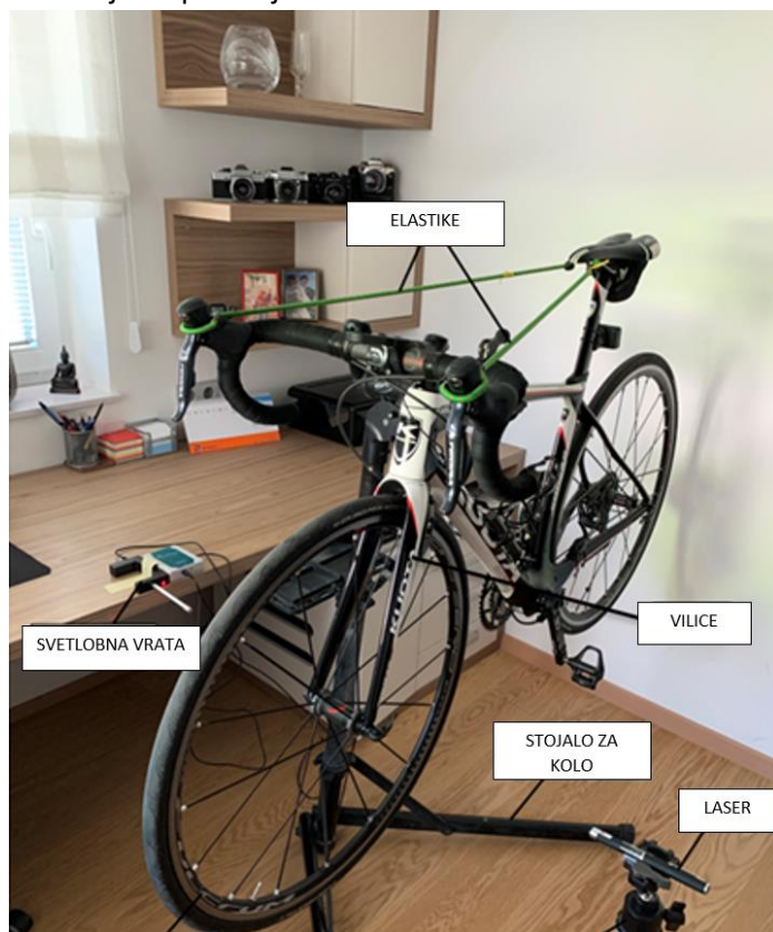
Slika 3: Eksperiment: Zaustavljanje kolesa
