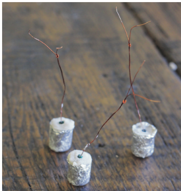
Slika 3.2: Izdelane kapsule goriva z vžigalniki.
