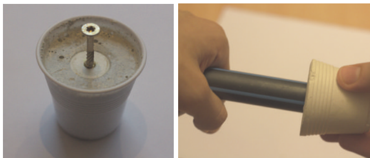
Slika 3.4: Priprava in uporaba mavčnega orodja za zatiskanje cevi.
