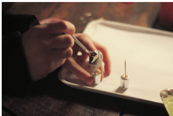
Slika 3.1: Polnjenje modelov iz aluminijaste folije z gorivom.
