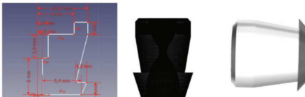
Slika 3.3: Skica z merami erozijsko odporne šobe levo, na sredini model šobe de Laval in desno model čepa.
