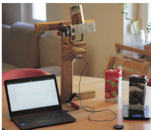
Slika 3.9: Prikaz postopka umeritve silomera.
