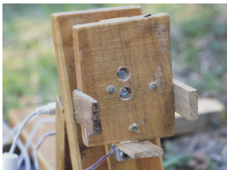
Slika 3.7: Leseno ležišče na silomeru z magneti za “ujetje” zaščitne pločevinke z motorjem.
