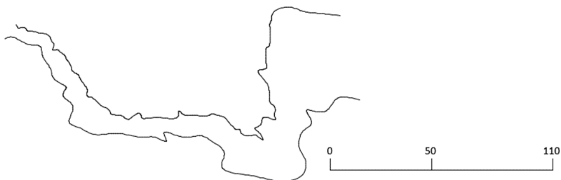
Slika 30: Načrt rudnika mangana pod Šmarjetno goro iz podatkov terestričnega laserskega skeniranja.
