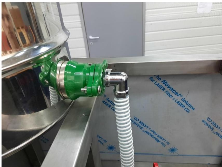
Slika 22: Nadgradnja sistema izpusta delovne snovi
