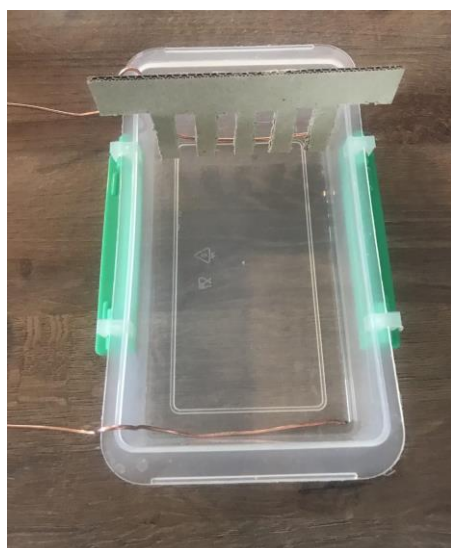
Slika 12: Namestitev glavnika iz kartona v posodi (lasten vir)
