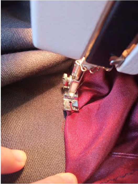
Slika 47: Šivanje nove strukture na osnovni material
