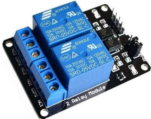
Slika 6: Arduino rele (vir naveden v virih sik)
