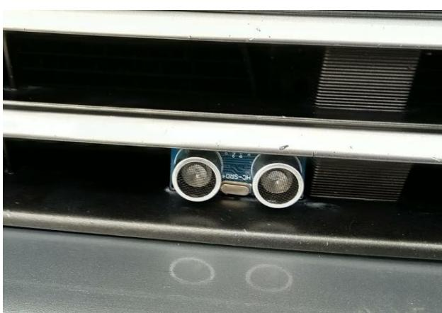
Slika 19 pritrjen ultrazvočni senzor v maski (lasten vir)
