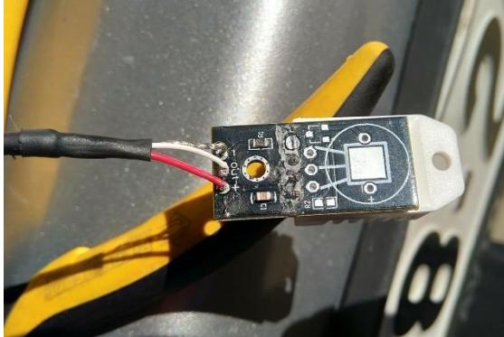
Slika 15 DHT 22 med vgradnjo (lasten vir)
