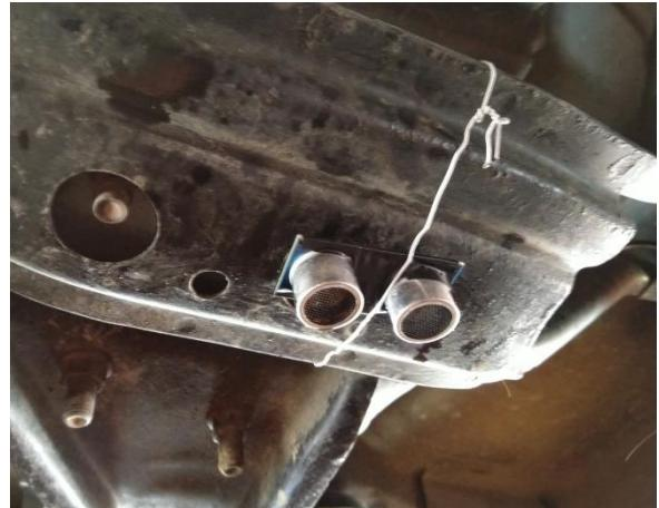
Slika 20 pritrjen ultrazvočni senzor (lasten vir)
