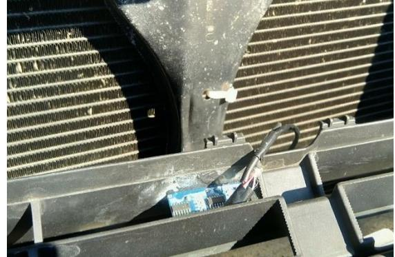
Slika 16 pritrjevanje ultrazvočnega sledilnika (lasten vir)
