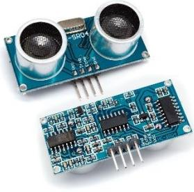
*Slika 7 ultrazvočni sledilnik
