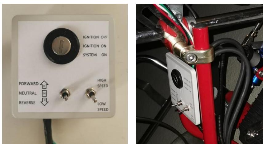
Slika 22: Razvodnica z nameščenimi stikali in nalepko
