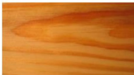
Slika 15: Tangencialni prerez debla
