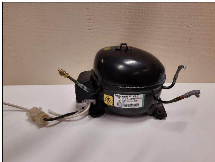
Slika 1: Kompresor Embraco EMX 26CLC
