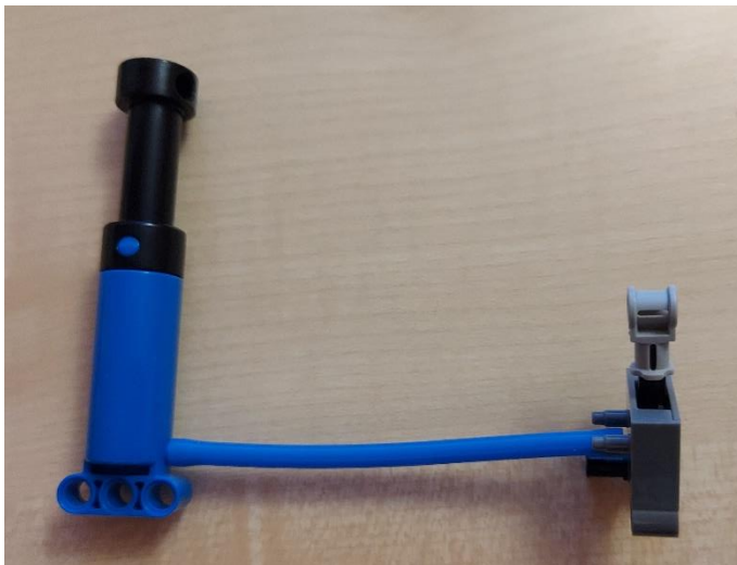
Slika 12 Lego ročni kompresor (ne poganja ga elektromotor) in stikalo
