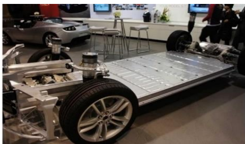
Slika 6 Baterijski modul Tesle Model S, električnega avtomobila s teoretičnim dosegom kar 652 km (po ciklu WLTP)
