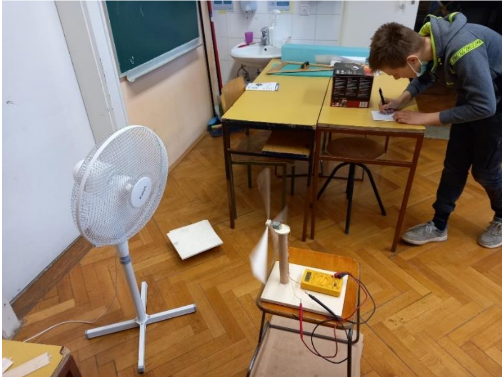
Slika 17 in 18 : Merjenje in zapisovanje napetosti
