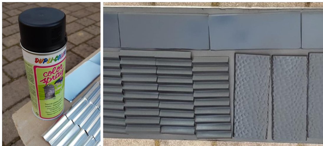
Slika 9 Barvanje solarnih ploščic s črno mat barvo (vir: lasten)
