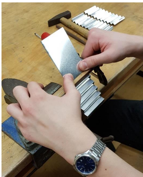
Slika 8 Izdelava solarnih ploščic z žagastim profilom (vir: lasten)
