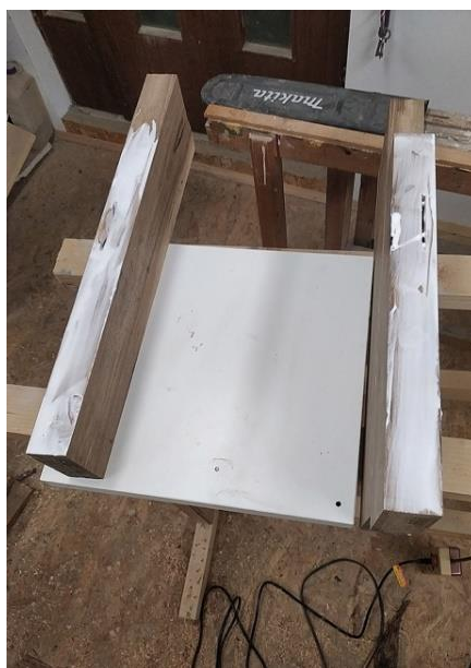
Slika 19: Lepljenje kosov lesa. (Vir: Lastni)
