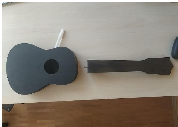
Slika 10: Sestavljanje trupa in vratu. (Vir: Lastni)
