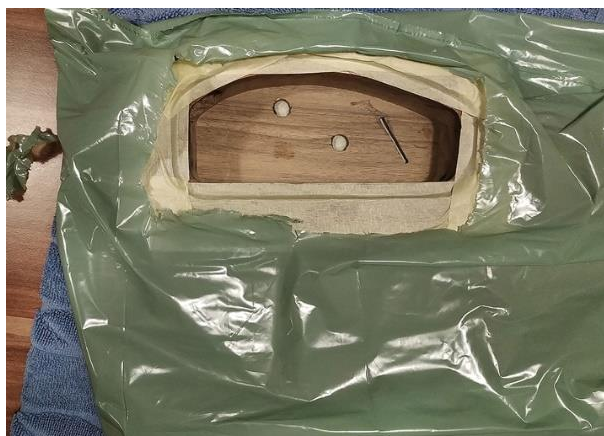
Slika 41: Zaščita pred barvanjem. (Vir: Lastni)
