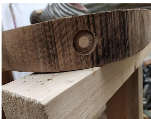
Slika 25: Luknja za električni priključek iz zunanje strani. (Vir: Lastni)
