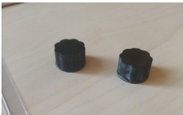
Slika 45: Nadomestna gumba izdelana s 3D tiskalnikom. (Vir: Lastni)
