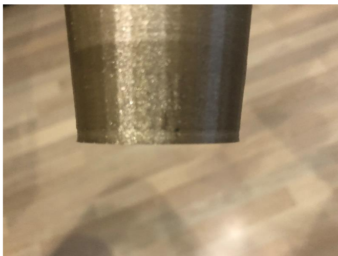
Slika 32: Kozarec natisnjen s filamentom PETG-pomanjkljivost 2
