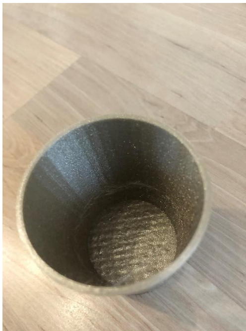
Slika 31: Kozarec natisnjen s filamentom PETG-pomanjkljivost 1
