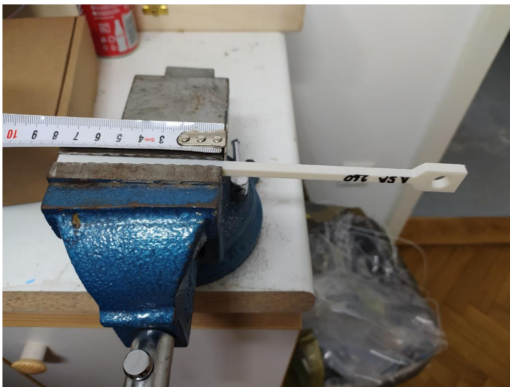
Slika 3. Standardiziran predmet v primežu. Merilni trak prikazuje dolžino vpetja predmeta v primež.
