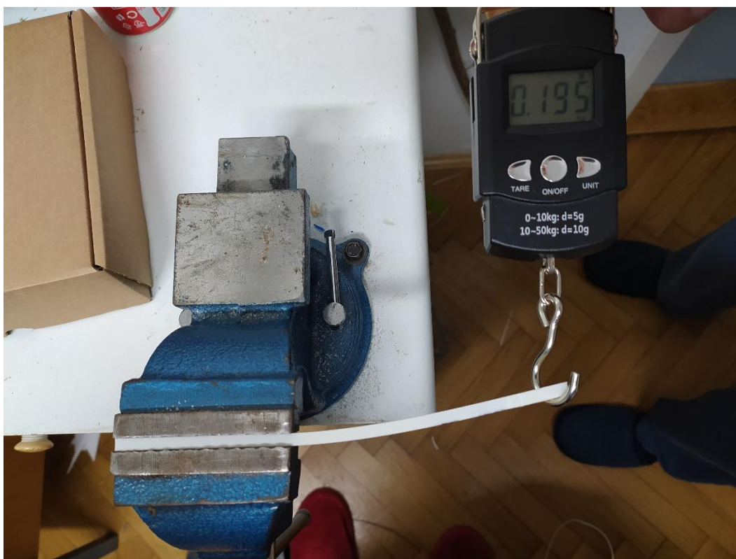
Slika 4. Merjenje trdnosti standardiziranega predmeta s silomerom.
