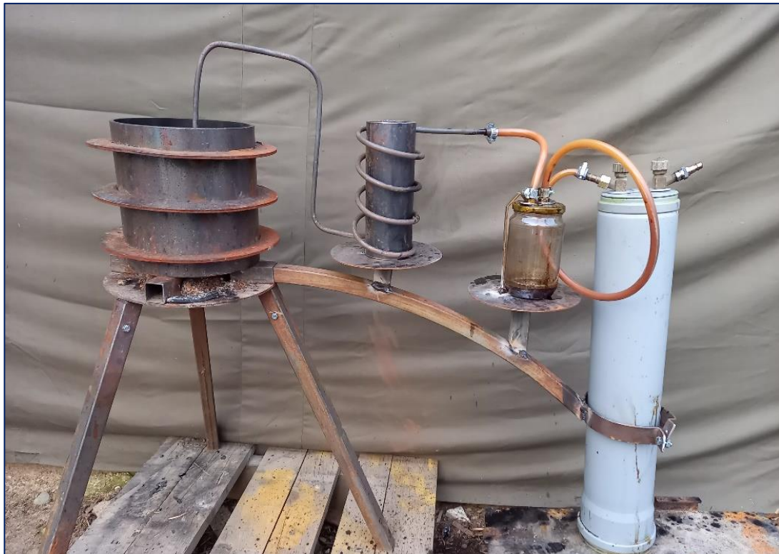
Slika 32: Končni izdelek gazifikatorja s hladilnikom, filtrom in gazometrom (lastni vir)
