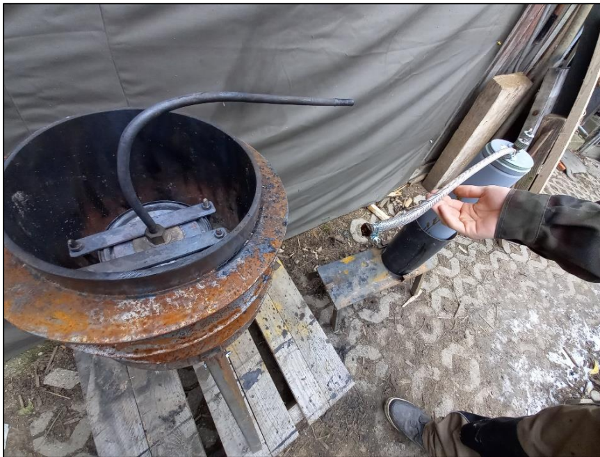
Slika 30: Stopljena cev gazometra (lastni vir)
