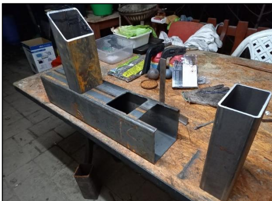
Slika 10: Razrez elementov raketne peči (lastni vir)
