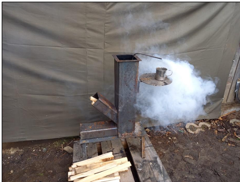
Slika 12: Test kombinirane raketne peči (lastni vir)
