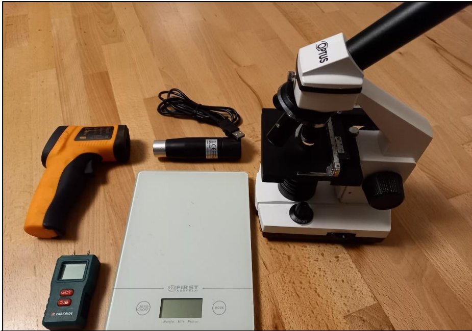
Slika 5: Merilni inštrumenti: mikroskop, termometer, digitalna tehtnica, merilec vlage
