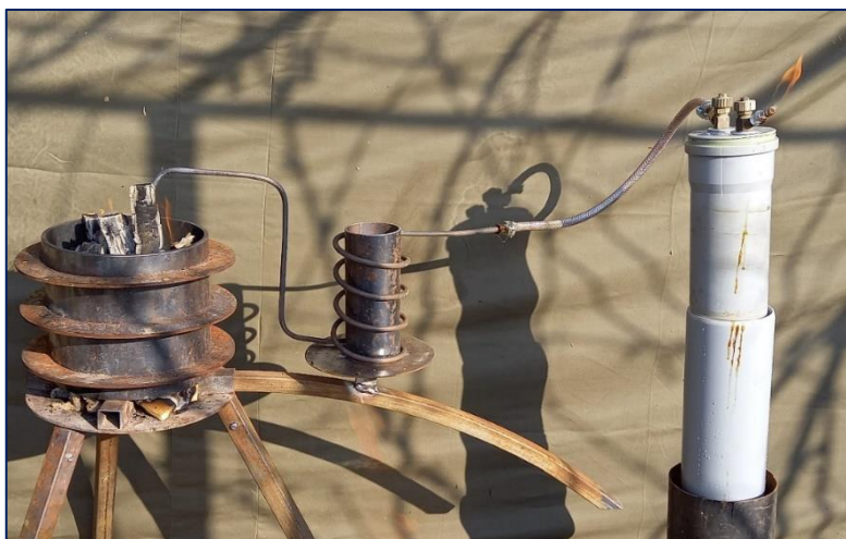
Slika 31: Sistem z novim hladilnikom plina (lastni vir)
