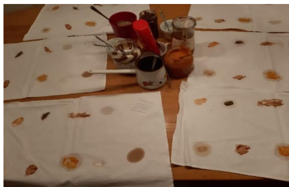
Slika 19: Nanos madežev na pripravljene krpe bombaža
