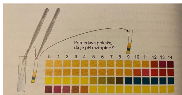
Slika 4: Merjenje pH raztopine z univerzalnim indikatorskim papirčkom
