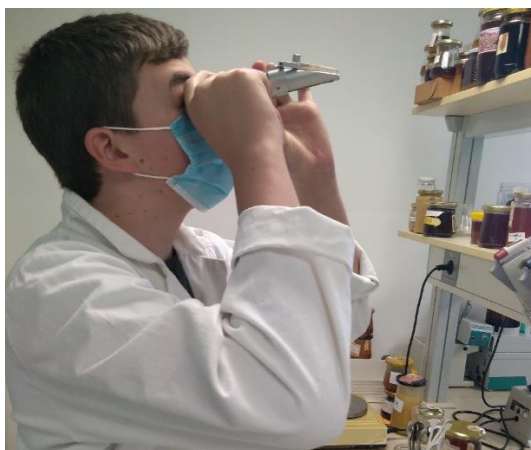
Slika 14: Merjenje vode v medu z refraktometrom (Vir: Osebni arhiv, Peter Puškarić)
