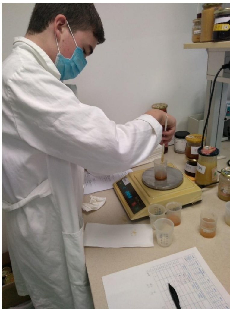
Slika 16: Tehtanje medu za merjenje električne prevodnosti (Vir: Osebni arhiv, Peter Puškarić)
