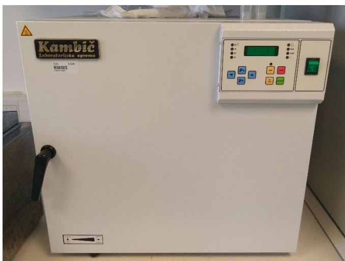
Slika 11: Segrevanje vzorca pri določeni temperaturi v toplotni komori (Vir: Osebni arhiv, Peter Puškarić)
