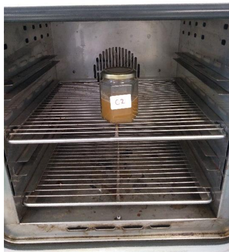
Slika 11: Segrevanje vzorca pri določeni temperaturi v toplotni komori (Vir: Osebni arhiv, Peter Puškarić)
