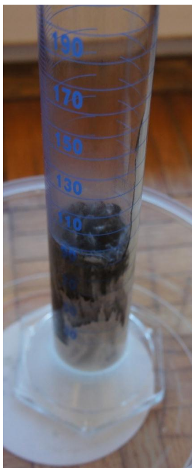
Slika 9: Reakcija razpada vodikovega peroksida po dodanem vzorcu manganovega dioksida. Foto: Vid Kodrič in Val Povalej
