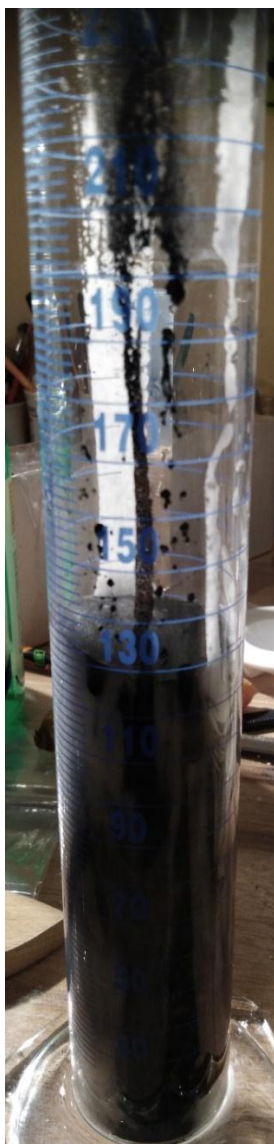
Slika 15: Reakcija razpada vodikovega peroksida po dodanem vzorcu manganovega dioksida strtega s kremenčevim peskom. Foto: Vid Kodrič
