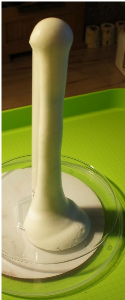
Slika 8: Reakcija razpada vodikovega peroksida po dodanem vzorcu kvasa. Foto: Vid Kodrič in Val Povalej
