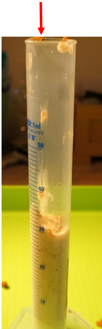
Slika 5: Reakcija razpada vodikovega peroksida po dodanem vzorcu korenja. Foto: Vid Kodrič in Val Povalej
