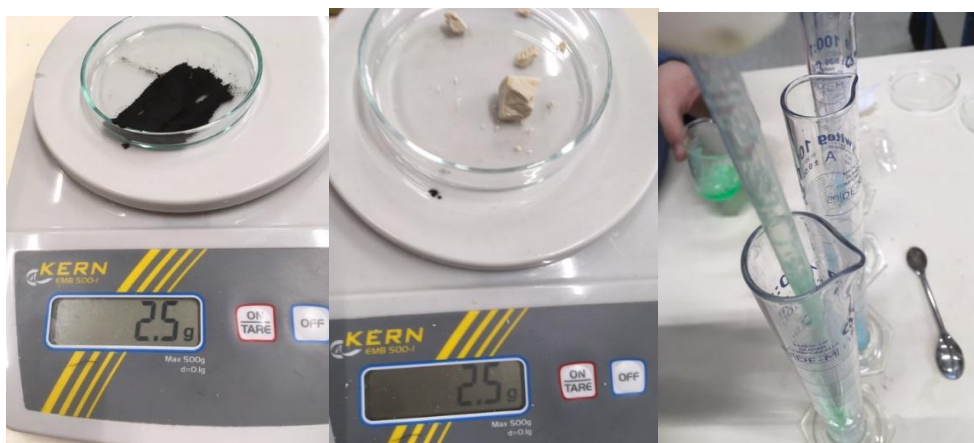
Slika 3: Natehtana 2,5 gramski vzorca kvasa in MnO 2 ter dodajanje vodikovega peroksida v merilni valj. Foto: Val Povalej
