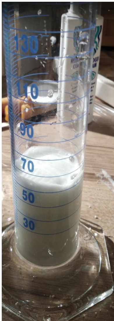
Slika 13: Reakcija razpada vodikovega peroksida po dodanem vzorcu jeter, ki je bil strt s kremenčevim peskom. Foto: Vid Kodrič
