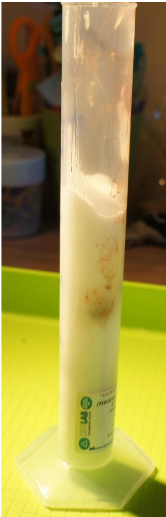
Slika 7: Reakcija razpada vodikovega peroksida po dodanem vzorcu jeter. Foto: Vid Kodrič in Val Povalej
