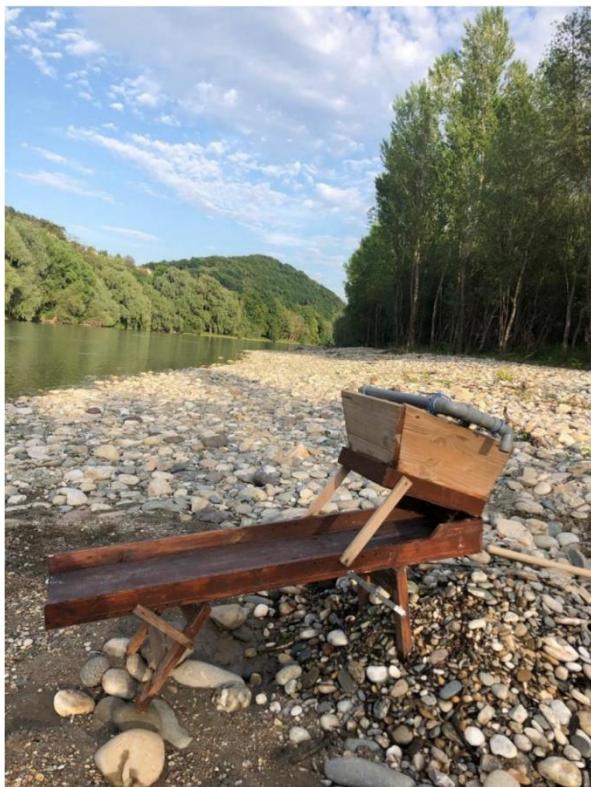
Slika 18: Iznajdljiva uporaba starega izpiralnika z moderno črpalko
